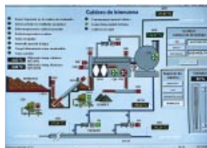
La central de calor està totalment automatitzada, fet que permet visualitzar i modificar tots els paràmetres de funcionament de la instal·lació des d'un ordinador central.
